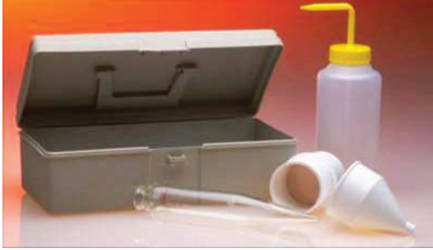
Şekil 2.8: Sondaj çamuru kum miktarı ölçüm kiti.
