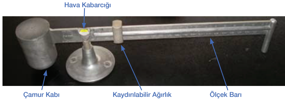
Şekil 2.7: Sondaj çamuru terazisi.
