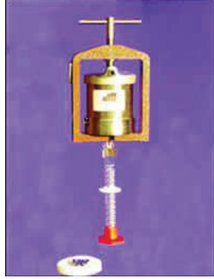
Şekil 2.4.a ve 2.4.b: Sondaj çamuru filtrasyon testi amaçlı mekanik presler.
