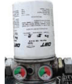
ŞEKİL 3.2. Hidrolik yağ filtresi.
