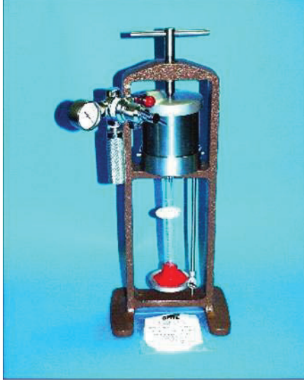
Şekil 2.4.a ve 2.4.b: Sondaj çamuru filtrasyon testi amaçlı mekanik presler.
